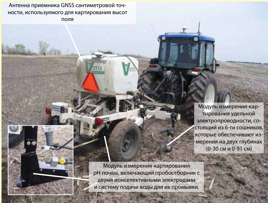
Рис. 3. Передвижная сенсорная платформа Veris® с блоками измерения-картирования удельной электропроводности и pH почвы («Верис Технолоджис, Инк.», г. Салина, штат Канзас, США), оборудованная приемником GNSS сантиметровой точности Trimble AgGPS® 442 («Тримбл Навигейшн Лтд.», г. Саннивейл, штат Калифорния, США).
