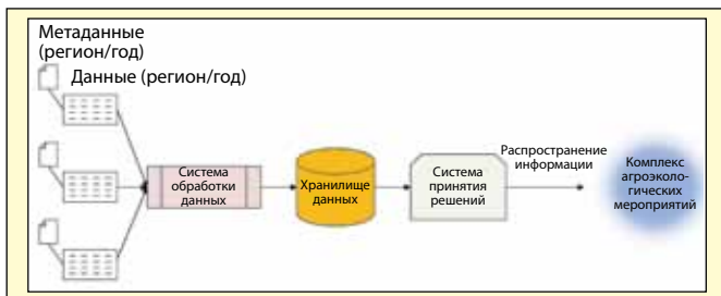
Рис. 5. Концептуальная модель процесса сбора и обработки данных в большом географическом масштабе
