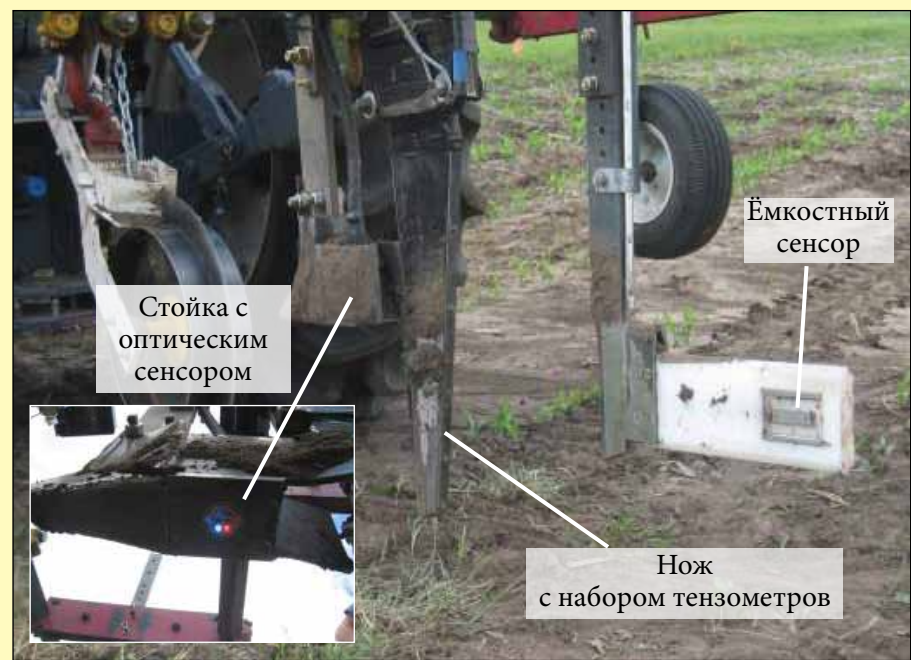
Рис. 2. Опытный образец, состоящий из механических, электрических и оптических сенсорных компонентов (Университет Небраски-Линкольна, г. Линкольн, штат Небраска, США).
