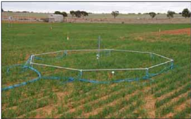
Рис.2. Один из восьми кольцевых экспериментальных участков с обогащением воздуха углекислым газом на поле в Уолпеапе, штат Виктория. Восемь фоновых участков, расположенных на достаточном удалении от экспериментальных участков, использовались для сравнения.
