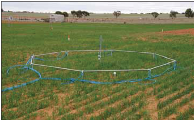
Рис.2. Один из восьми кольцевых экспериментальных участков с обогащением воздуха углекислым газом на поле в Уолпеапе, штат Виктория. Восемь фоновых участков, расположенных на достаточном удалении от экспериментальных участков, использовались для сравнения.
