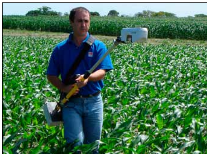
Автор проводит измерения показателя NDVI на поле кукурузы в Паране (провинция Энтре-Риос).
